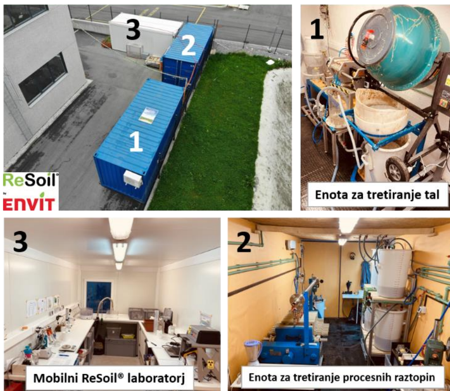
Slika 1: Mobilna enota: demonstracija optimiziranega postopka pranja tal v večjem merilu bo potekala na mobilni pilotni remediacijski napravi, ki ima zmogljivost pranja tal 50 kg na serijo.
